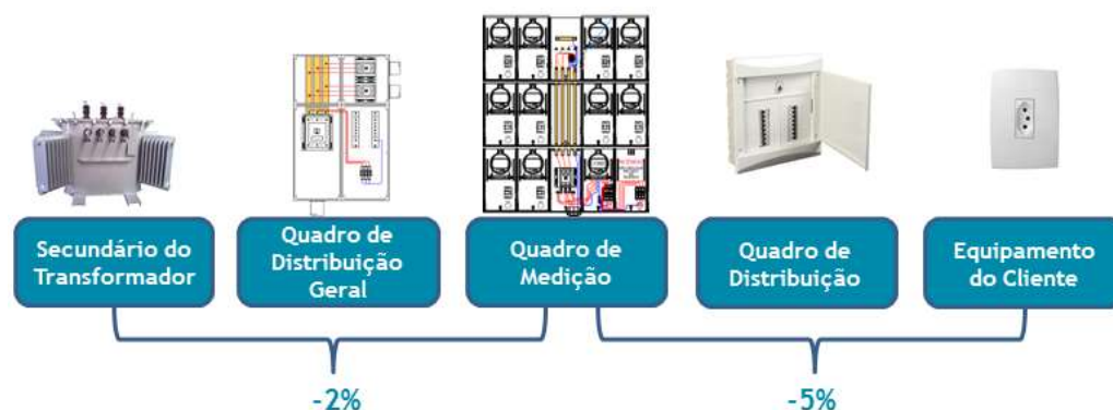
Figura 1: Queda de Tensão
