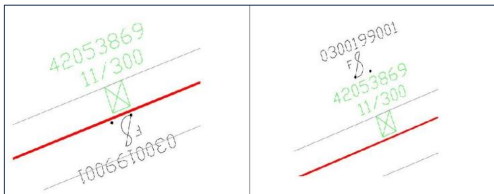
Figura 02. Representação correta de equipamento especial em poste.
