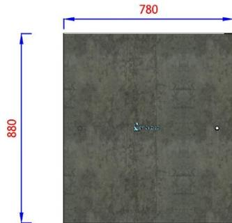
VISTA EM PLANTA - TAMPA EM CONCRETO EXTERNA
