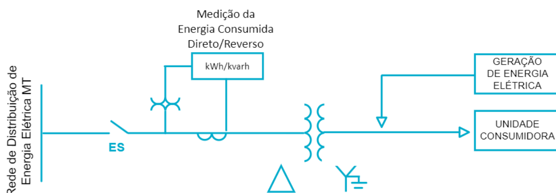
Figura 4 - Representação de ligação para centrais geradoras com conexão em MT e Medição em MT
