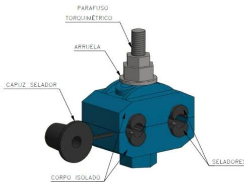
Figura 1 - Conector derivação perfurante para rede secundária isolada.
