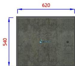
VISTA EM PLANTA - TAMPA CONCRETO EXTERNA
