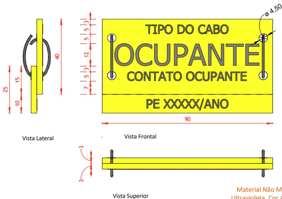
Material Não Metálico, Resistente a Luz Ultravioleta, Cor Amarela e em Alto Relevo.
