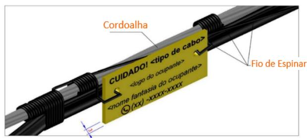
Fixação de Plaqueta em Cordoalha com Fio de Espinar
