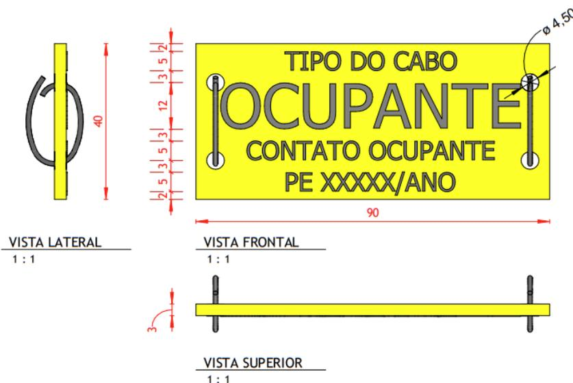
Plaqueta Modelo com adequações de posicionamento de Informações e Incluso do N° de Projeto Elétrico (PE).
