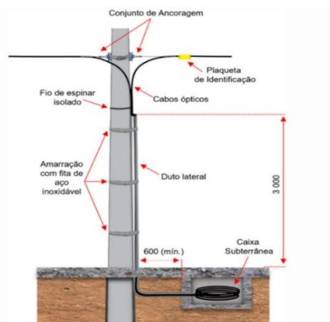
Figura 02. Disposição lateral dos dutos de condutores da **Ocupante**.
