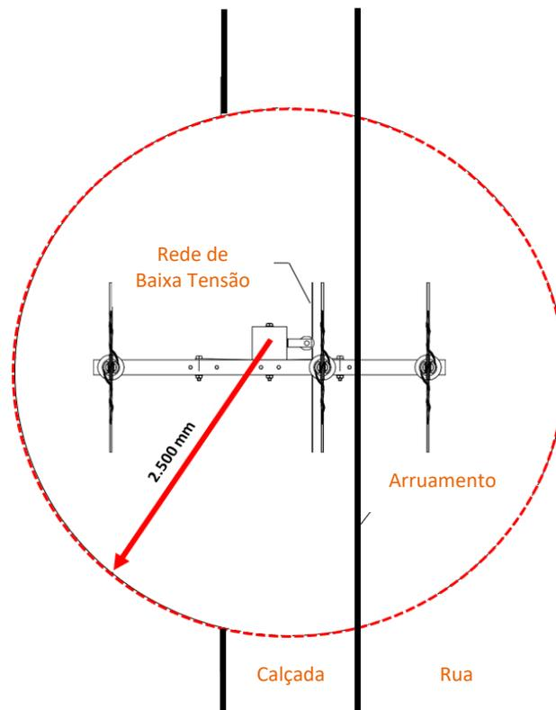
Para os postes equipados (transformadores, religadores, bancos capacitores etc.), o raio passa a ser de 3.000 mm.
