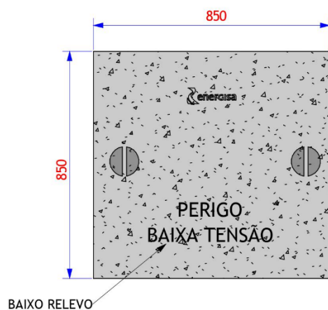
TAMPÃO DE CONCRETO
