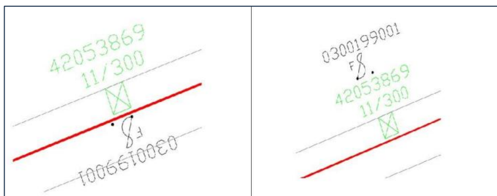
Figura 02. Representação correta de equipamento especial em poste.
