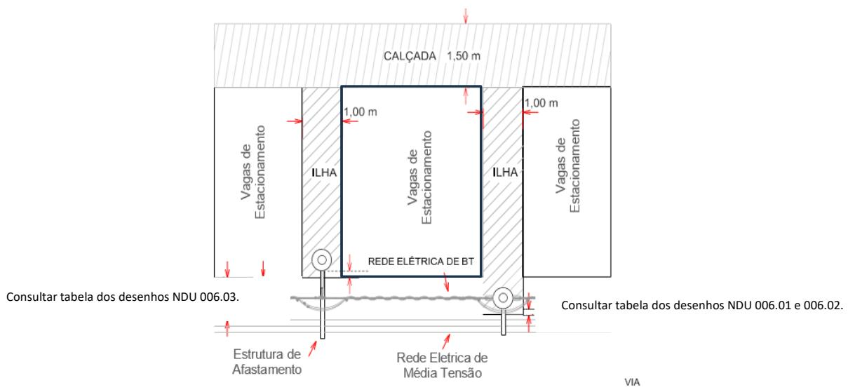
Figura 07. Locação de postes ao lado de vagas de estacionamento.
